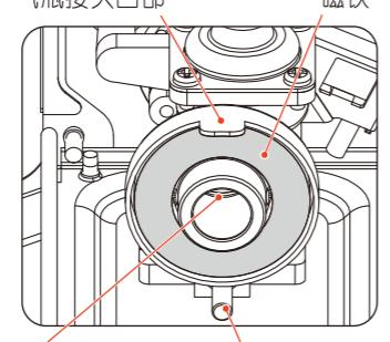
压力感应安全装置 气瓶安装安全装置
